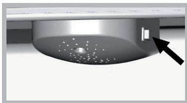
Функція Active Oxygen активна, коли пристрій працює відповідно свого циклу (в повторювальному режимі до деактивації (відключення) функції), емісія озону визначається включенням світлодіода зеленого кольору всередині холодильної камери на пристрой, опція stand by (очікування – без емісії озону) визначається включенням світлодіоду блакитного кольору.
