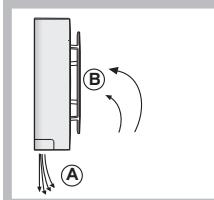
Интегрированная система охлаждения воздуха AIR максимально увеличивает циркуляцию воздуха в отделении, повышая эффективность работы испарителя; при открывании дверцы быстро восстанавливает оптимальную температуру в холодильнике: выдуваемый воздух (A) охлаждается при соприкосновении с холодной на неплю, в то время как нагретый воздух (B) всасывается (см. рис.).
