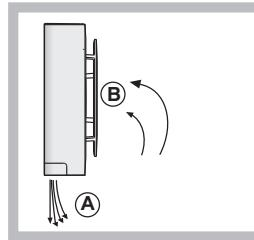
Функція ПОВІТРЯ прискорює циркуляцію повітря, підвищуючи ефективність випаровувача та сприяючи якнайшвидшому досягненню оптимальної температури всередині холодильника після кожного його відкривання. Повітря, що видувається (A), охолоджується при контакті з холодною стінкою, тоді як тепліше повітря (B) всмоктується (див. рисунок).
